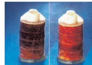
Abb. 4: Heizölfilter (Betrieb ohne und mit V3 MEGA)
